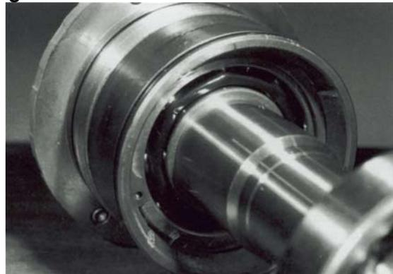
22. La tuerca de fijación (No. 124) y la arandela (No. 125) ya se pueden extraer del eje (No. 105). Deseche la arandela.
